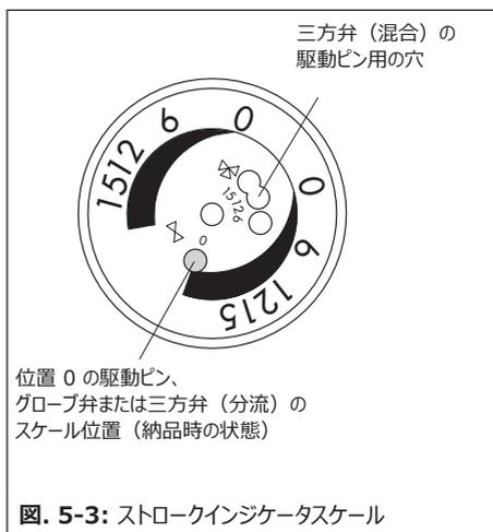
図. 5-3: ストロークインジケータスケール
