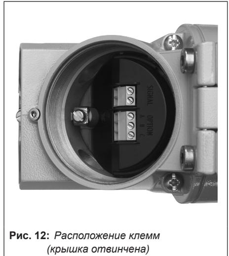
**Рис. 12:** Расположение клемм (крышка отвинчена)
