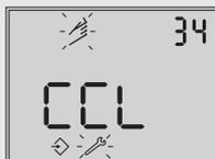
Направление закрытия (направления вращения, заставляющее клапан двигаться в положение CLOSED (выводится на дисплей позиционера)
