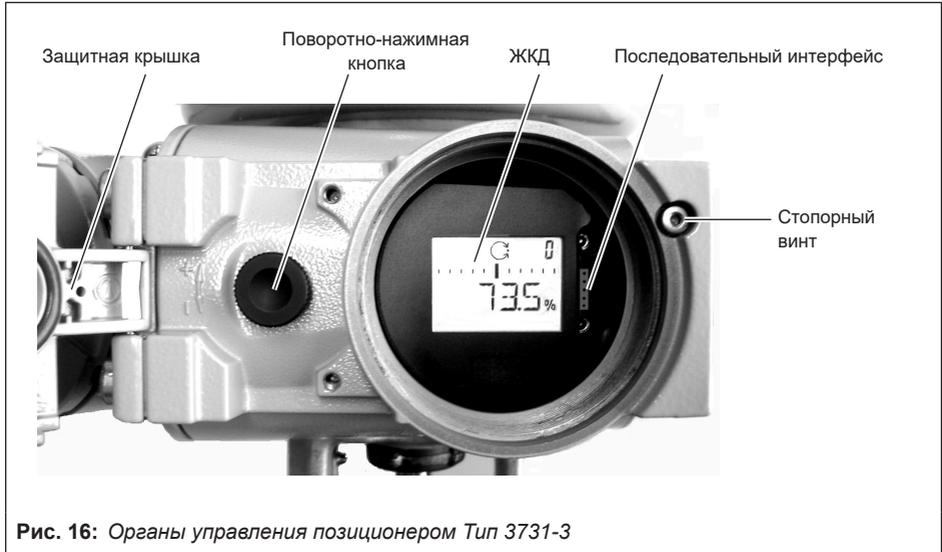
Рис. 16: Органы управления позиционером Тип 3731-3
