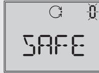
Клапан перемещается в положение безопасности. Если позиционер инициализирован, на дисплее отображается текущее положение клапана в %.
