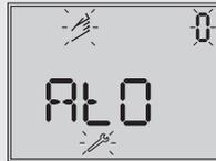
Считывание положения безопасности
