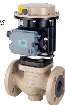
Bild 2: Antrieb Typ 3372 · Antriebsfläche 350 cm 2 · mit direkt angebautem Stellungsregler Typ 3725
